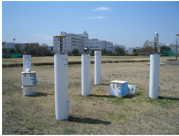
写真 4-4-1. アンテナ定数検定測点
