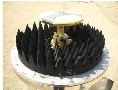
写真 4-3-2. 国土地理院構内端点（アンテナ収納部）
