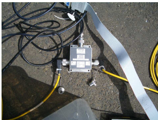
写真 4-6-5. アンテナスプリッター（移動局側のみ）
