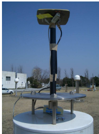
写真 4-4-3. アンテナと温度センサー
