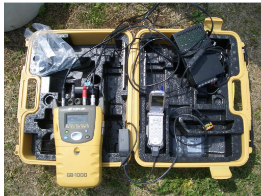
写真 4-6-2. 固定局の構成（受信機・モデム等）
