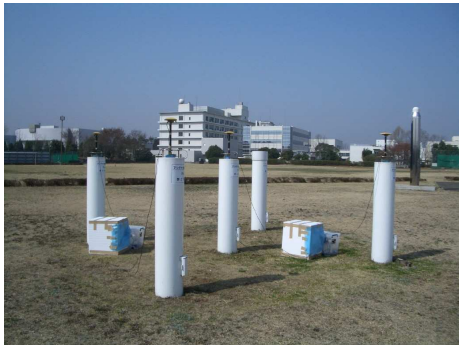
写真 4-5-1. アンテナ定数検定測点
