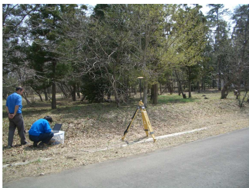
写真 4-6-3. RTK 測量の移動局（国土地理院構内）
