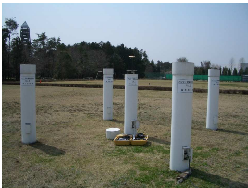
写真 4-6-1. RTK 測量の固定局（アンテナ検定測点 No. 1）
