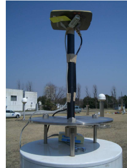
写真 4-5-2. アンテナと温度センサー
