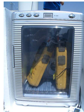
写真 4-5-4. 温冷蔵庫（温度設定 30°C）
