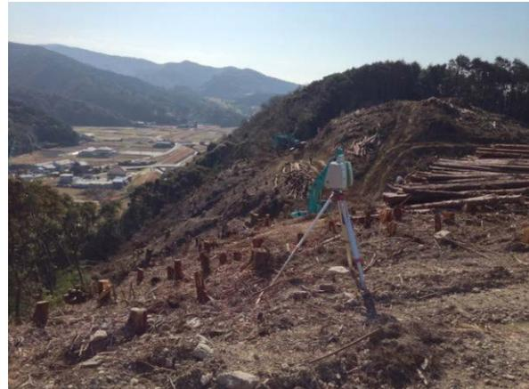
写真-1 3Dスキャナー計測状況
