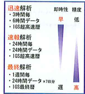
図4 電子基準点データ解析における即時性と精度との関係
