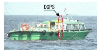
図3 DGPSを搭載した誘導船
