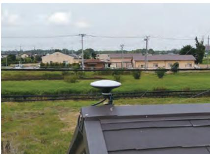
図2 当社屋の屋根に設置したGNSS基準局
