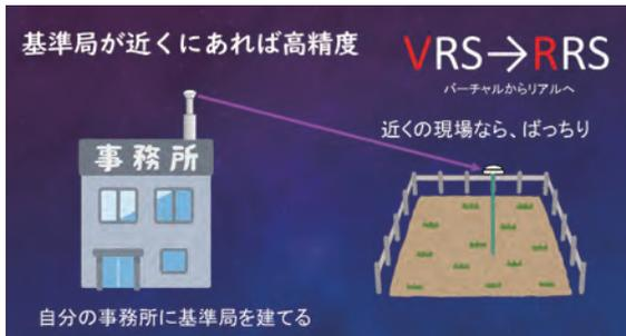
図4 近距離でのRTK測量
