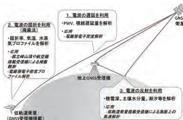
GNSSによる大気計測手法の概念図。
