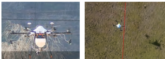
図 1-8 単独測位 GPS 機直線飛行の精度実験（水平誤差 50cm 程度、垂直誤差 50cm 程度）
