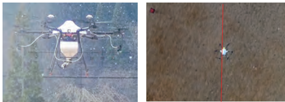
図 1-7 D-RTK 搭載機直線飛行の精度実験（水平誤差 20cm 程度、垂直誤差 30cm 程度）
