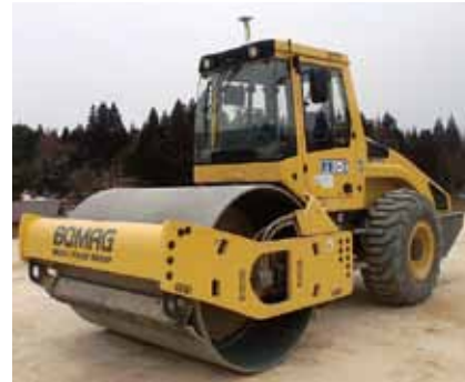
▲転圧システム取付状況
