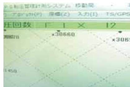
▲GNSS 配信での FIX 画面 GNSS 使用時:12 個取得 (FIX)
