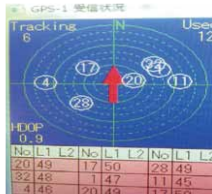
▲GPS 配信での FIX 画面 GPS 使用時:6 個取得 (FLOAT)
