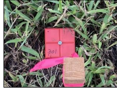
その他の基準点 (プラスチック杭)
