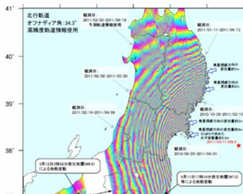
合成開口レーダー(SAR)と電子基準点(GPS連続観測点)の融合解析による地殻変動(暫定)
