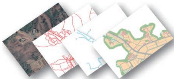
航空写真 地籍図 ラインデータ (水路, 側溝等) ポリゴンデータ (建物, 農地など)
