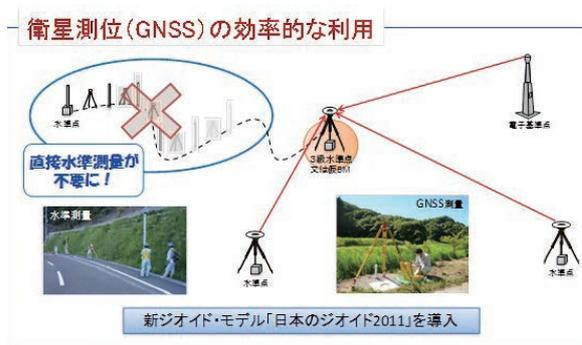
図-1 衛星測位 (GNSS) の効率的な利用
