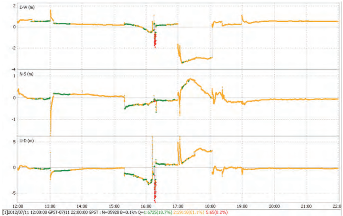
図 3 ネットワーク型 RTK 配信によるキネマティック測位結果（上段：南北方向偏差、中段：東西方向偏差、下段：高さ方向偏差、緑色が Fix、黄色が Float、赤色が単独測位）
