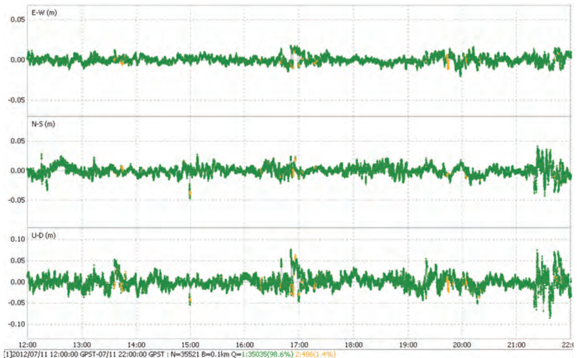
図 4 ローカル RTK によるキネマティック測位結果（上段：南北方向偏差、中段：東西方向偏差、下段：高さ方向偏差、緑色が Fix、黄色が Float、赤色が単独測位）
