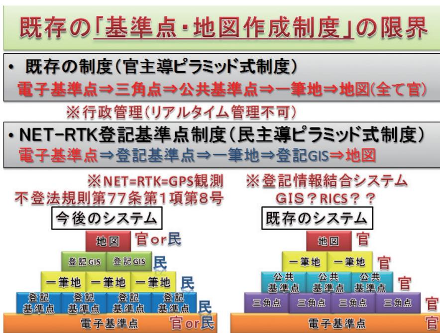
するものでなく一筆地の測量図から地図を作成することである。つまり、調査士が日常作成する地積測量図を作成するために街区調査（街区内の土地全部を観測して一筆の土地境界線を確定する調査）を行うがそれら一連の作業で観測される多角測量情報、街区調査図、地積測量図をXML化して集積すればよいのではないか。もしこれらのデータが任意座標であったなら、街区調査図上に記載された多角点、引照点、境界標識の内から天空の空いた点で街区エリアを囲むように5点程度を抽出し、NET-RTK-GPS観測値で座標変換を行いジグゾーパズルの1ピースとしてGISに入力し、繋ぎ合わせは電子基準点網で囲まれたエリア内でパズル同士平均計算を行うことができればリアルタイムに更新するシステムが確立されたいと考える。
