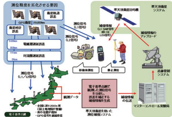
図1 測位補強概要システムの概要
