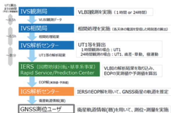
図3. VLBI 観測による計測結果の提供フロー
